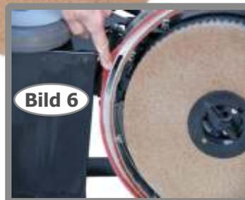
Ist die Ansaugöffnung stark verschmutzt, sollte man die ganze Absaugleiste abnehmen und reinigen! Dazu die beiden Rändelmutter abschrauben und den Schlauch nach oben abziehen. Bei älteren Modellen erst die Schlauchschelle lösen. (Bild 7).
