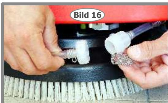
Das Frischwasser-Filter der Maschinen ab 08/2011 lässt sich durch Aufschauben des Gehäuses leicht reinigen (Bilder 13 bis 16).
