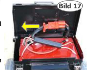
den Akkumulatorkasten öffnen und den Stecker nach links abziehen.
